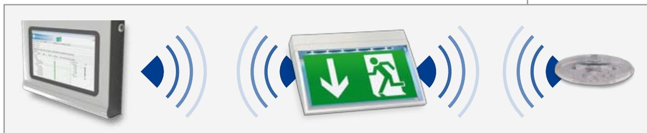
Jede mit WirelessProfessional ausgerüstete Leuchte kann auf der europaweit zugelassenen Frequenz von 868 MHz Kontakt mit anderen Leuchten oder mit der Zentrale aufnehmen und ihren eigenen sowie den Status anderer im System angemeldeter Leuchten übertragen. Die Reichweite innerhalb von Gebäuden beträgt dabei maximal 25–30 m. Durch die Funkfrequenz von 868 MHz stellt auch eine Stahlbetondecke zwischen zwei Etagen kein unüberwindbares Hindernis dar.
